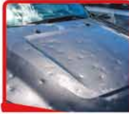
DOLU HASAR ONARIMI
